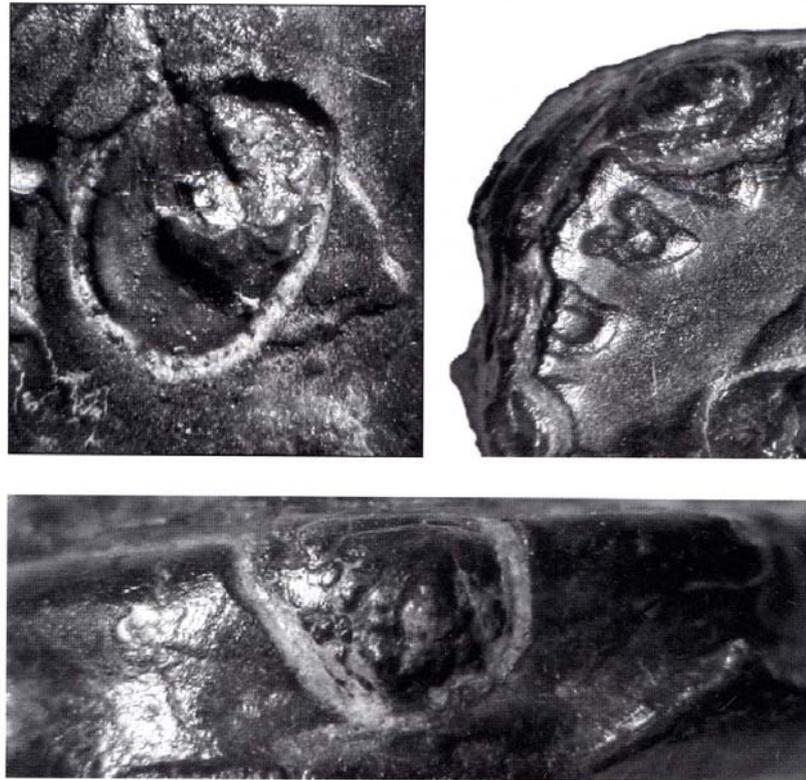
Abb. 5 a–c: Durch Volumenvergrößerung des Kupfers abgesprengte Teile der Bronzeschicht.
